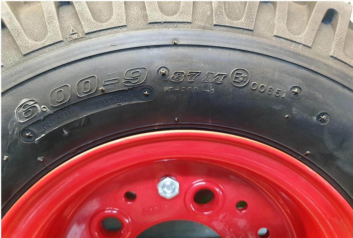
Voorbeeld van band met belastingindex 87 (maximaal 545 kg) en snelheidsindex M (maximaal 130 km/uur)
