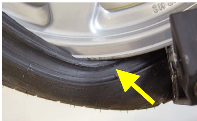
Ilustracja 26. Duże naprężenie podczas montażu
