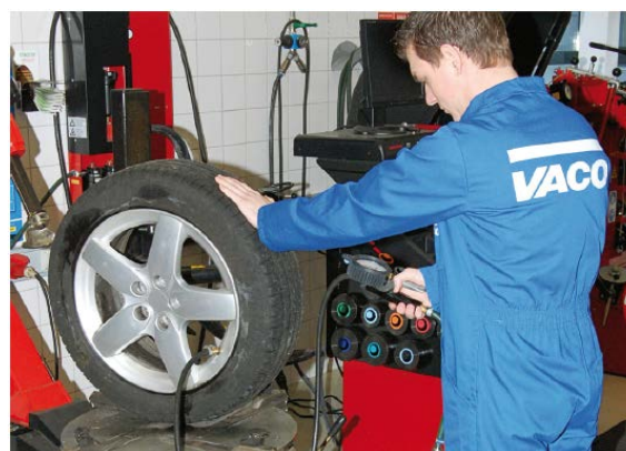
Ilustracja 27. Właściwa pozycja podczas pompowania opony
