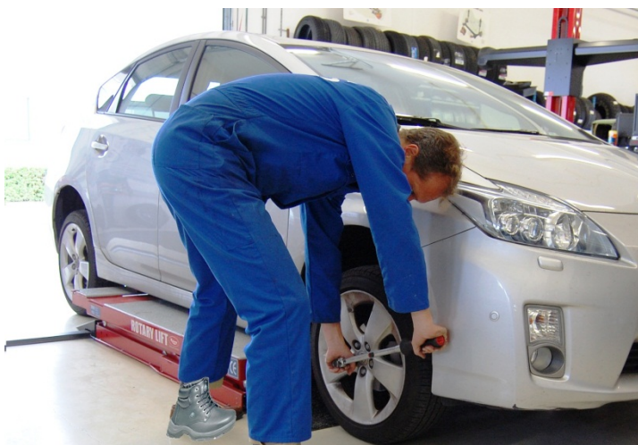
Ilustracja 35. Dokręcanie przednich kół znajdujących się już na podłożu jest trudne i niedokładne
