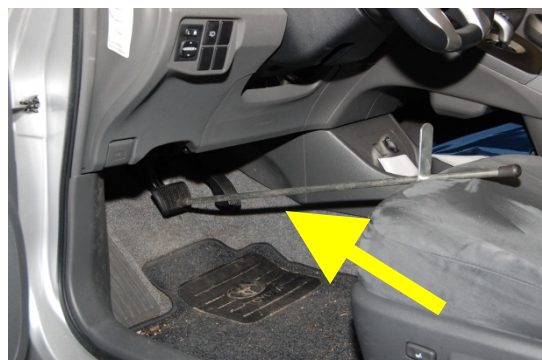
Ilustracja 34. Blokada hamulca jest szybka i dokładna
