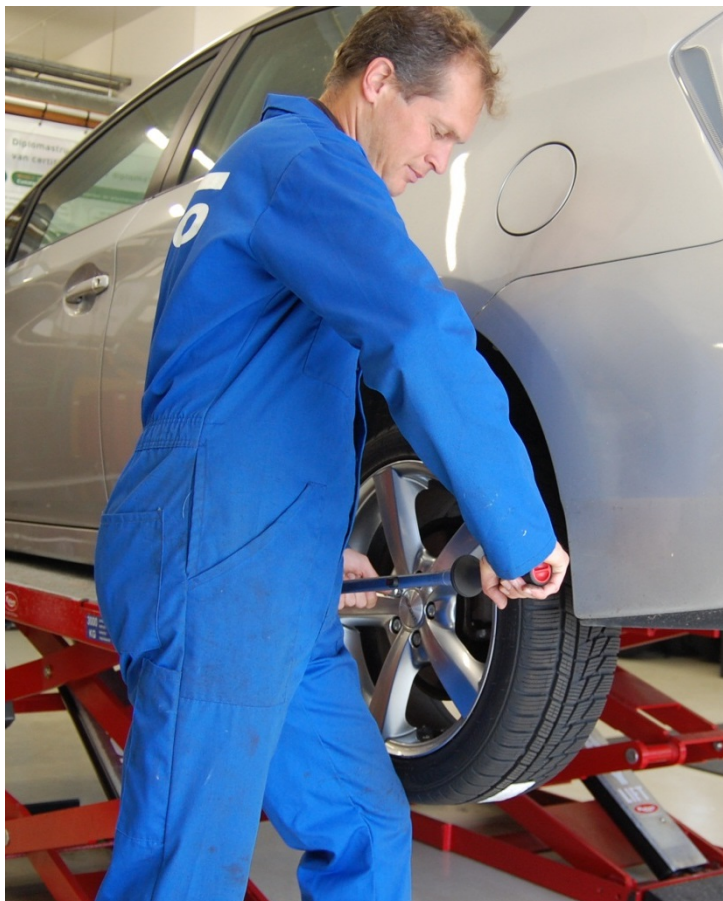
Ilustracja 33. Zawsze należy stosować klucz dynamometryczny
