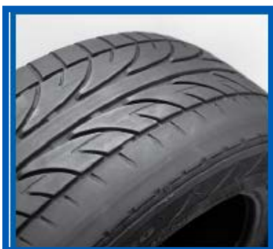
Ilustracja 15. Zużycie z powodu kąta pochylenia koła
