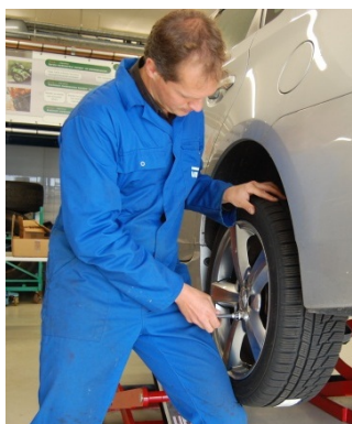
Ilustracja 31. Przytrzymać koło nogą w pozycji.
