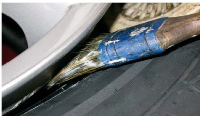
Ilustracja 20. Smarowanie stopki przed demontażem
