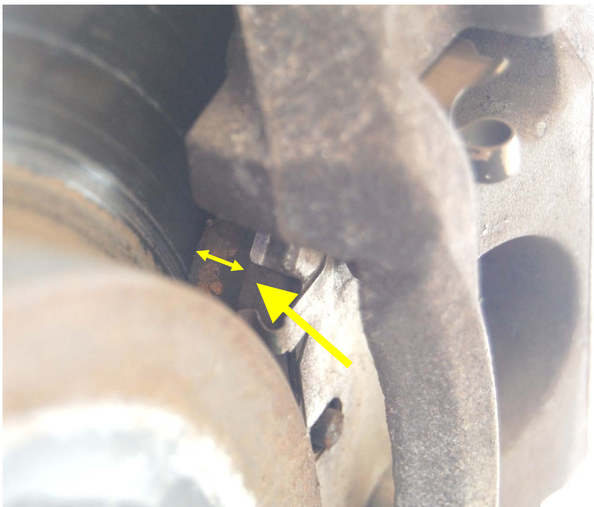
Ilustracja 11. Grubość klocków hamulcowych można łatwo sprawdzić po zdemontowaniu koła.
