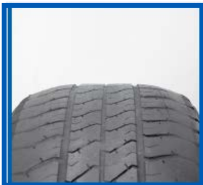
Ilustracja 12. Zbyt niskie ciśnienie
