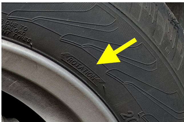
Ilustracja 24. Opony ze wskazanym kierunkiem
