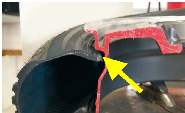
Ilustracja 21. Dobrze docisnąć stopkę w profilu głębokim felgi
