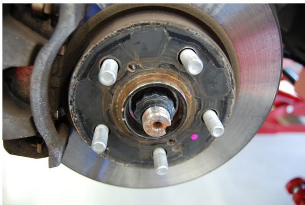
Ilustracja 28. Zapewnić, że piasta jest czysta
