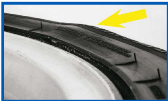
Ilustracja 18. Pęknięcie osnowy, wyrzuszenia
