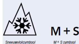
Afbeelding 5. M+S en het sneeuwvloksymbool
