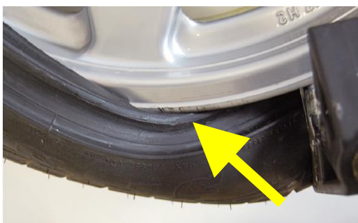
Afbeelding 26. Hoge spanning bij montage
