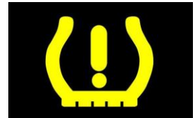
Afbeelding 8. Symbool als er een TPMS-systeem aanwezig is
