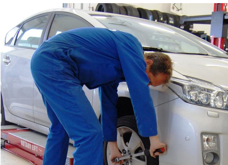
Afbeelding 35. Voorwielen aanhalen als wielen al aan de grond staan is zwaar en onnauwkeurig
