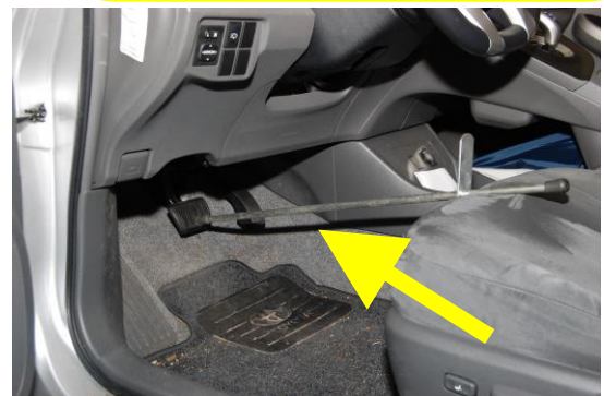
Afbeelding 34. Een remmenknecht is snel en nauwkeurig
