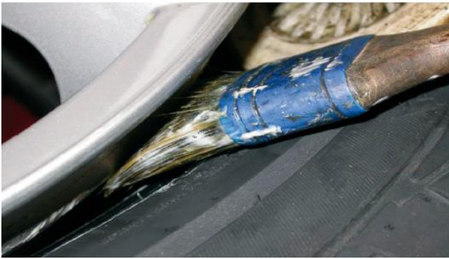
Afbeelding 20. Insmeren van de hiel voor demontage
