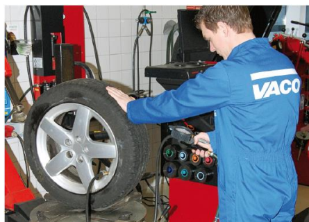
Afbeelding 27. De juiste positie bij het oppompen van een band
