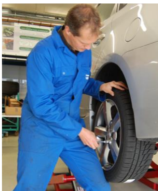
Afbeelding 31. Houd het wiel met je onderste been in positie
