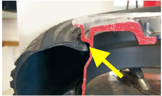
Afbeelding 21. Duw de hiel goed in het diepbed van de velg
