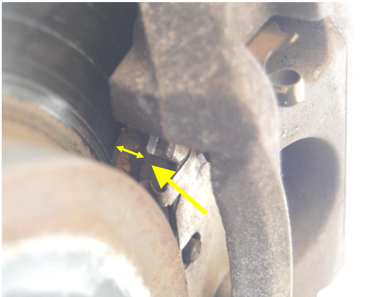
Afbeelding 11. De dikte van de remblokken is gemakkelijk te zien als het wiel is gedemonteerd.
