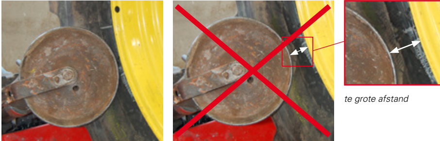
Afb. 5: rol op de juiste positie plaatsen Afb. 6: rol is niet goed geplaatst. De afstand tussen de rol en de velgrand is te groot
