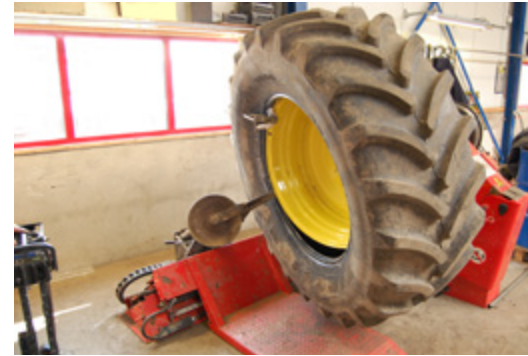
Afb. 19: hielklem monteren en band draaien
