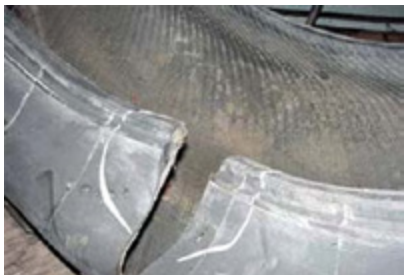
Afb. 42: band met grote kracht over veiligheidsrib gesprongen
