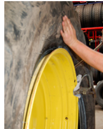
Afb. 20: band goed in het diepbed drukken
