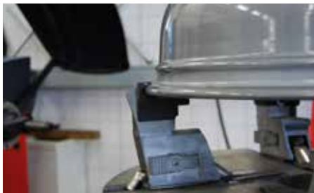
OPSPANNEN VAN BIJVOORBEELD MOTORFIETSWIELEN
