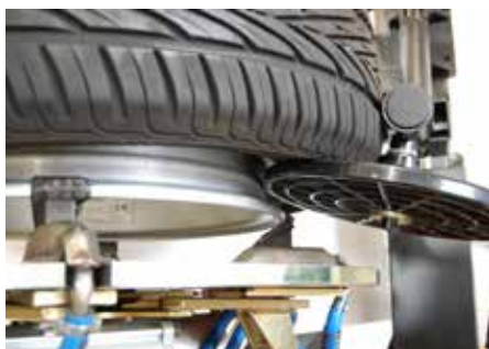
HULPARM HOUDT DEEL VAN DE BAND OMHOOG BIJ HET DEMONTEREN VAN DE TWEEDE HIEL
