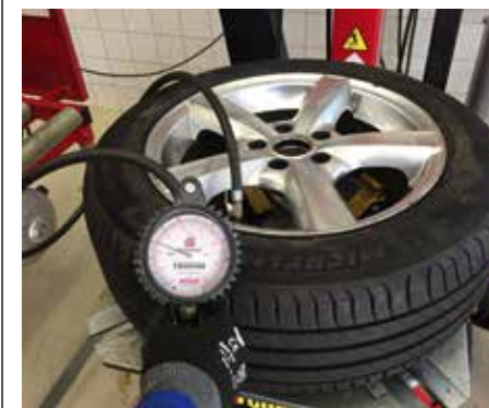
MAXIMALE DRUK BIJ HET ZETTEN VAN DE HIEL VAN EEN PERSONEN-AUTOBAND (ZETSPANNING)
