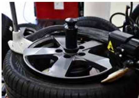
HULPARM OM DEEL VAN DE HIEL IN HET DIEPBED TE HOUDEN
