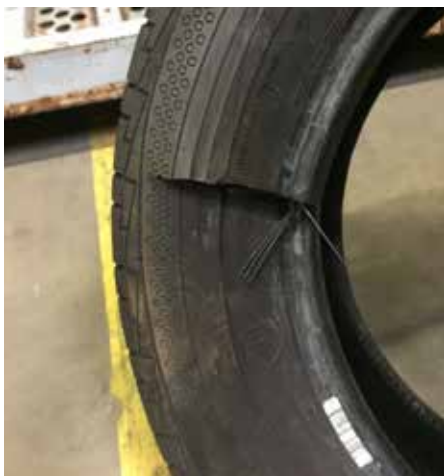
SCHADE ALS GEVOLG VAN MONTAGE BAND OP WIEL
