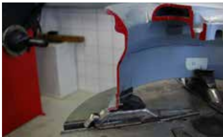
HET WIEL WORDT VAN BINNENUIT OPGESPANNEN
