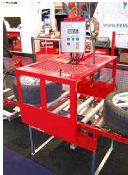
MONTAGESTRAAT MET POMPKLOK EN KOOICONSTRUCTIE
