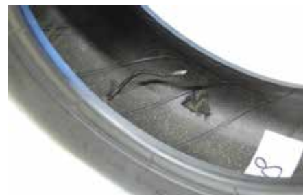
BAND MET SPIJKER EN KARKASSCHADE: ALTIJD DEMONTEREN
