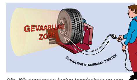
Afb. 64: oppompen buiten bandenkooi op een montageapparaat
