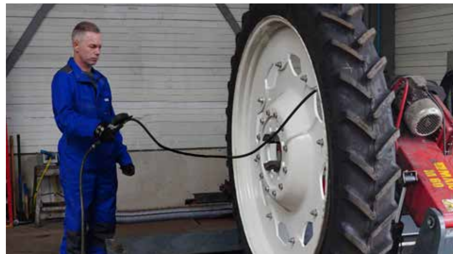
Afb. 58: positie monteur bij realiseren van voorspanning
