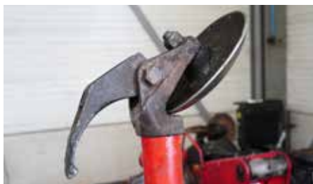
Afb. 5: (de)montagehaak (links) en montageschotel (rechts)
