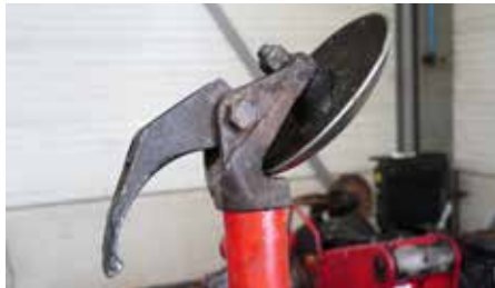
Afb. 5: (de)montagehaak (links) en montageschotel (rechts)
