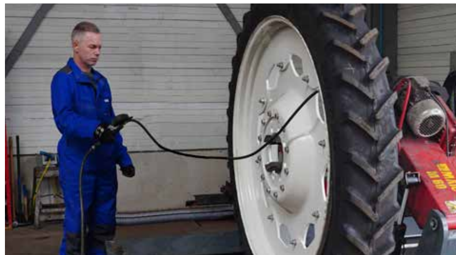
Afb. 58: positie monteur bij realiseren van voorspanning
