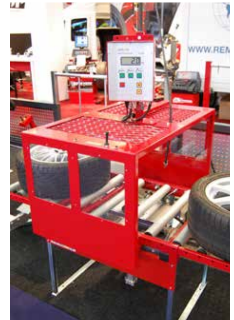
Afb. 16: montagestraat met pompklok en kooiconstructie
