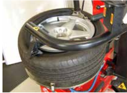
Afb. 9: hulparmen bij montageapparaat
