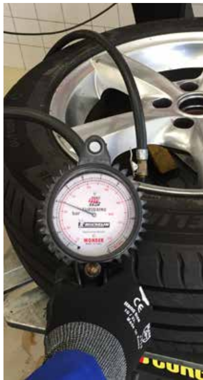
Afb. 17: maximale druk bij het zetten van de hiel van een personenautoband (zetspanning)
