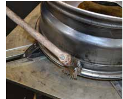
Afb. 3: insmeren hump en hoorn van de velg
