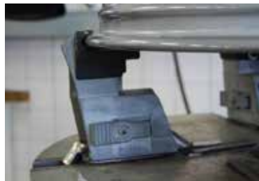
Afb. 6: opspannen van grote wielen en motorfietswielen
