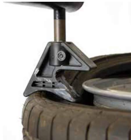
Afb. 13a: hulparm of klem die de hiel in het diepbed houdt tijdens montage
