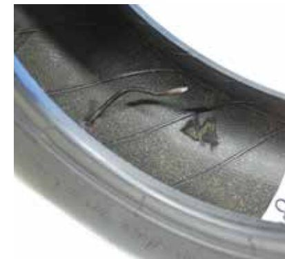
Afb. 23: band met spijker en karkasschade: altijd demonteren bij reparatie
