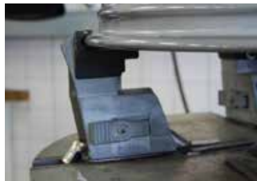
Afb. 6: opspannen van grote wielen en motorfietswielen
