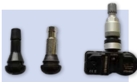
Afb. 21: v.l.n.r. een rubber ventiel, een hoge druk ventiel met metalen behuizing en een TPMS-ventiel
