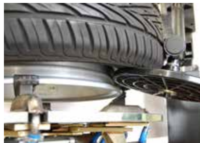
Afb. 12: hulparm om de onderste hiel los te maken
