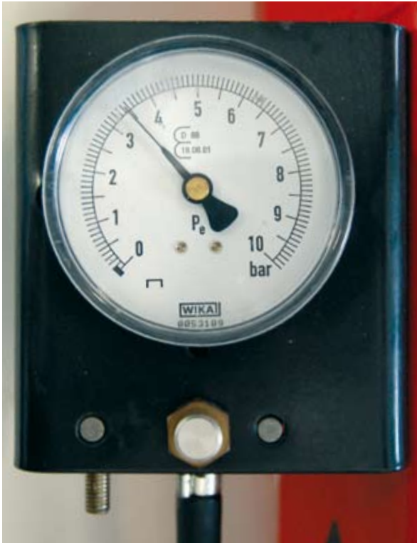
Afb. 17: maximale druk bij het zetten van de hiel
