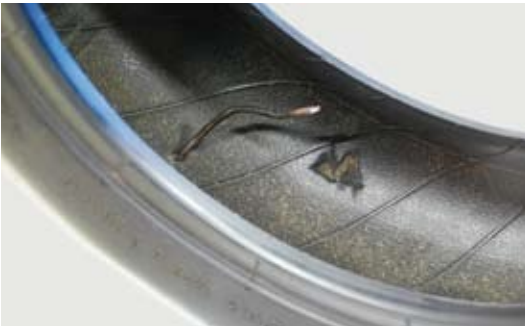
Afb. 23: band met spijker en karkasschade: altijd demonteren bij reparatie
