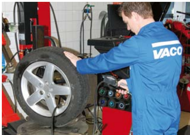
Afb. 14: sta bij het oppompen in de richting van het loopvlak
