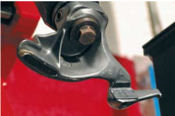
Afb. 7: montagekop met kunststof bescherming
