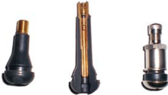
Afb. 21: v.l.n.r. een volrubber ventiel, een opengewerkt ventiel met metalen kern en een metalen ventiel
