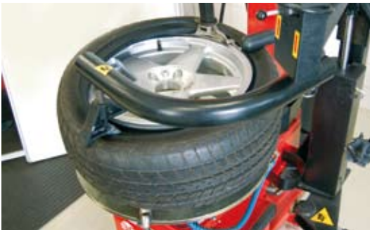
Afb. 8: hulparmen bij montageapparaat
