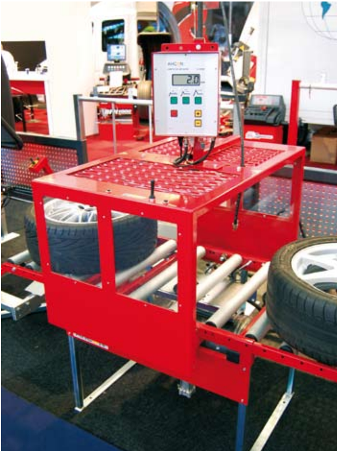
Afb. 16: montagestraat met pompklok en kooiconstructie
