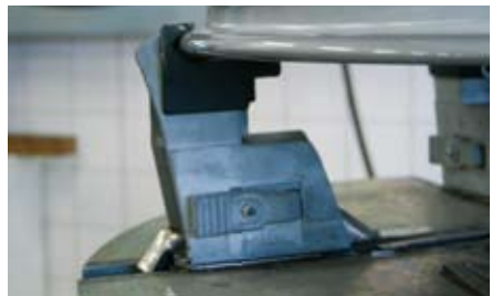
Afb. 6: opspannen van grote wielen en motorfietswielen
