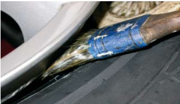
Afb. 3: insmeren hump en hoorn van de velg
