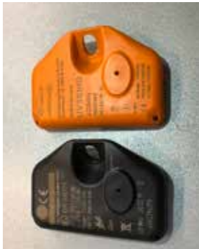
AFB. 1.4: TPMS-SENSOREN ACHTER HET VENTIEL
