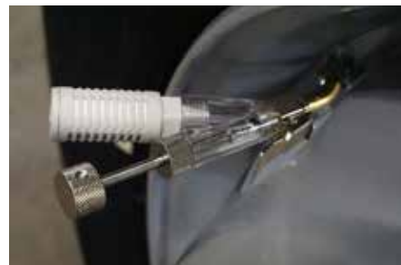
AFB. 4: GELUIDDEMPER BIJ HET LEEGLOPEN VAN BANDEN
