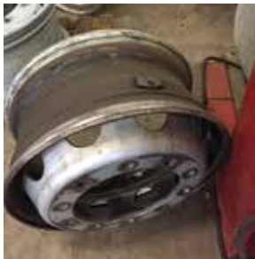
AFB. 1.6: TPMS-SENSOR ACHTER HET VENTIEL
