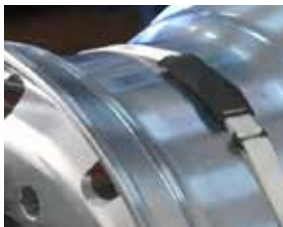
AFB. 1.7: TPMS-SENSOR IN DIEPBED
