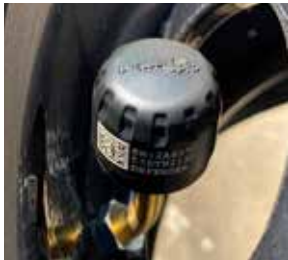
AFB. 1.3: TPMS-SENSOR OP HET VENTIEL
