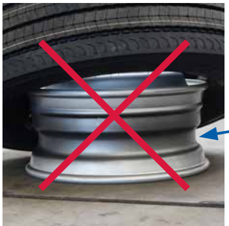
AFB. 3: VELGBED ZIT NIET AAN DE GOEDE KANT
