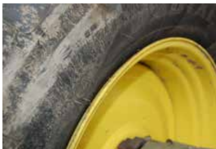
AFB. 14: HIEL NOG NIET VOLLEDIG GEZET BIJ 1 BAR VOORSpanNING
