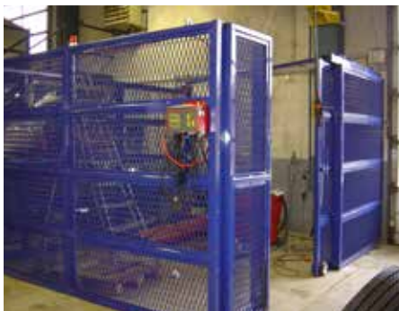
AFB. 10: KOOICONSTRUCTIE WAARBIJ DE BAND OP HET MONTAGEAPPARAAT WORDT OPGEpomPT
