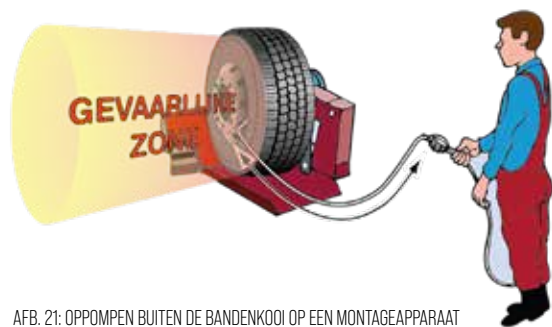
AFB. 21: OPPOMPEN BUITEN DE BANDENKOOI OP EEN MONTAGEAPPARAAT
