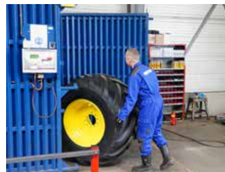
AFB. 11: BANDENKOOI. BIJ EEN Klapband WORDT DE vrijKOMENDE LUCHT VERSPREID DOOR DE METALEN PROFIELEN
