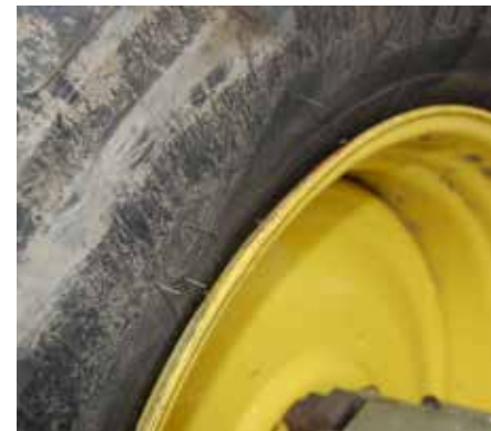
Afb. 59: hiel nog niet volledig gezet bij 1 bar voorspanning
