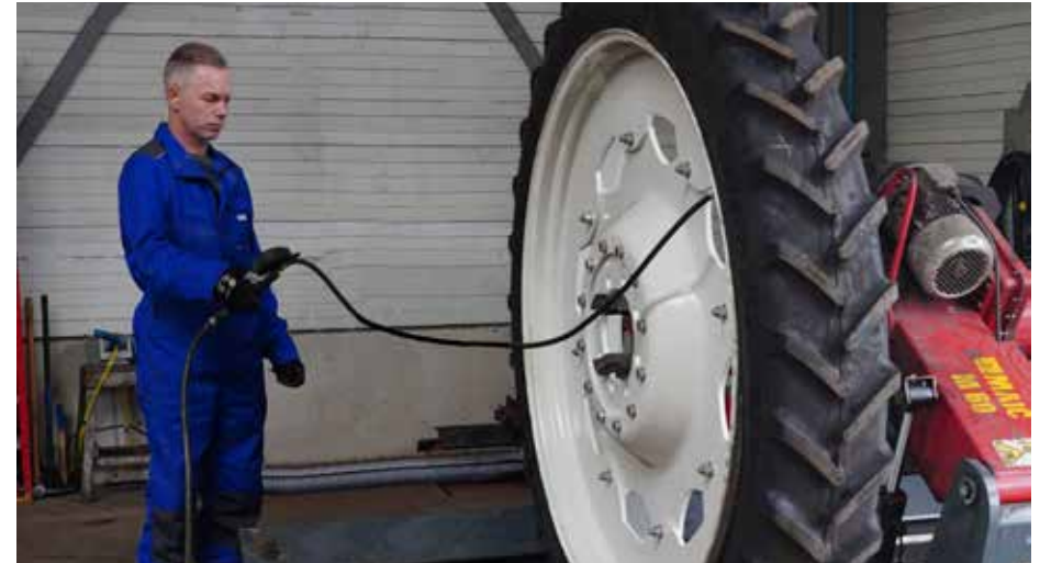
Afb. 58: positie monteur bij realiseren van voorspanning
