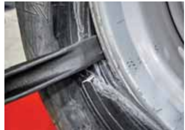
Afb. 10: methode 2: ruimte maken voor hiellichter
