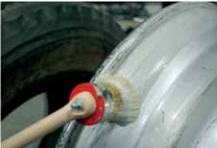
Afb. 13: breng montagepasta aan op het velgbed
