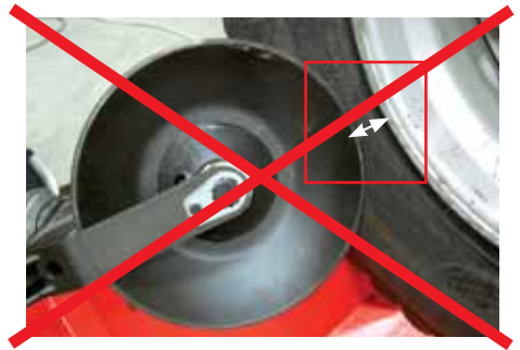
Afb. 6: de rol is niet goed geplaatst. De afstand tussen de rol en de velgrand is te groot
