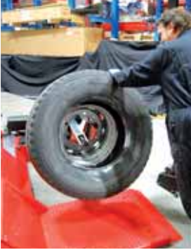
Afb. 15: licht de eerste hiel over het wiel
