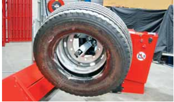
Afb. 16: de band geplaatst over de eerste hiel
