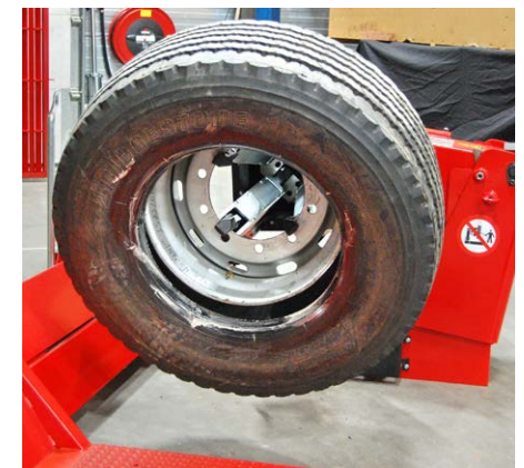
Afb. 17: de band geplaatst over de eerste hiel van het wiel.
