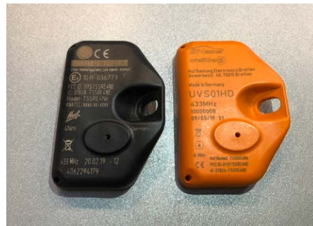
Afb. 0.3: TPMS sensor achter het ventiel.
