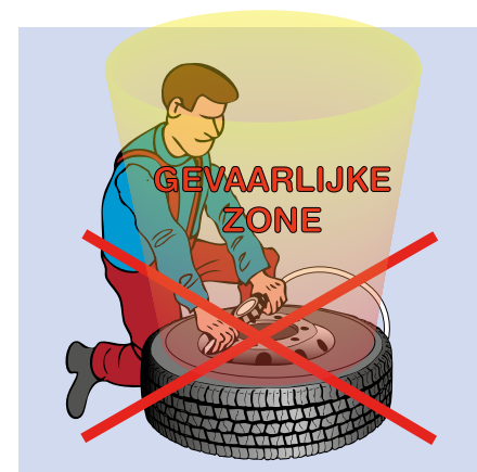
Afb. 34: leg de band nooit plat op de grond.
