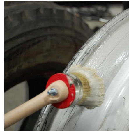
Afb. 14: breng montagepasta aan op het velgbed.
