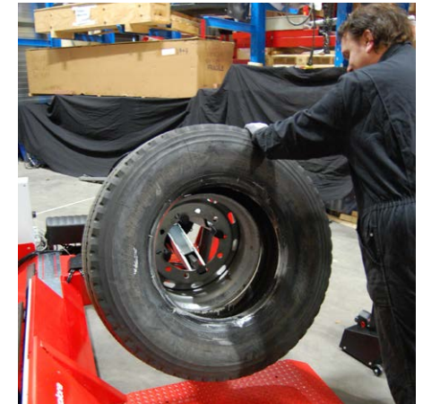
Afb. 16: licht de eerste hiel over het wiel.
