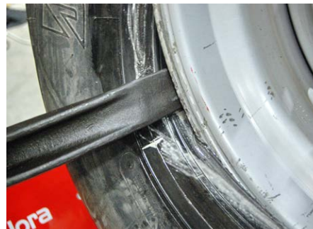
Afb. 11: methode 2 – ruimte maken voor hiellichter.
