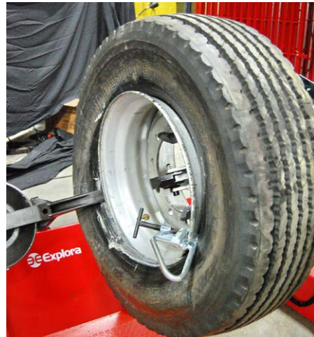
Afb. 19: De hulparm drukt de tweede hiel over de velgrand.
