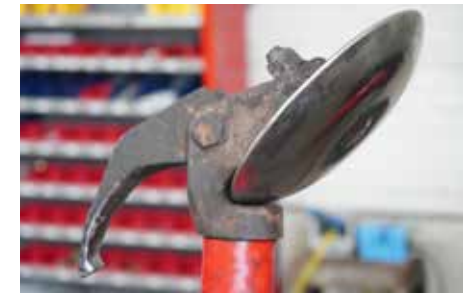
Afb. 5: (de)montagehaak (links) en hielschotel (rechts)
