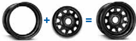
Afbeelding 0.1: velg en wielschijf vormen samen een wiel.
