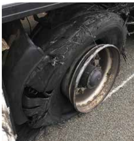
Afb. 36: doorgereden na plotseling ongecontroleerd luchtverlies.
