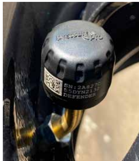
Afb. 0.3: TPMS sensor aan buitenkant ventiel
